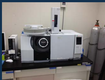
トリプル四重極型GC-MS/MS (GCMS-TQ8030 島津製作所)
