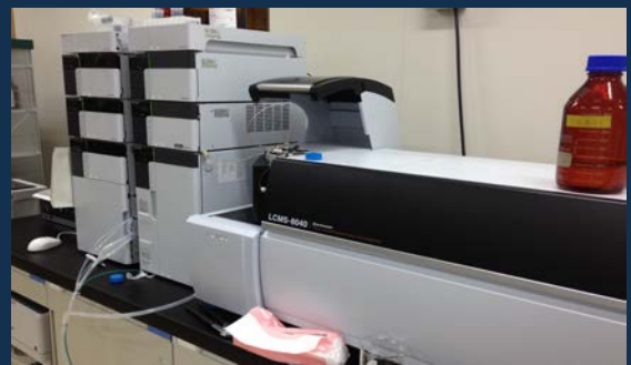
トリプル四重極型LC-MS/MS (LCMS8040 島津製作所)
